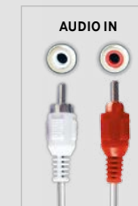
Audio-Eingang für Cinch-Kabel
